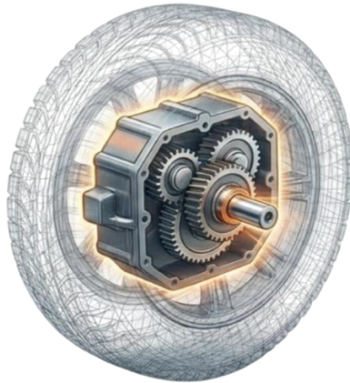
圖 11 輪轂馬達(In-wheel Motor)示意圖
