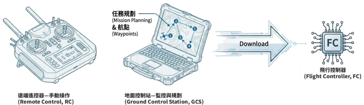
圖 11 遙導控 (Remote Control) 及任務規劃 (Mission Planning) 次系統示意圖
