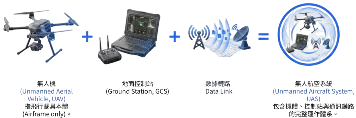
圖 1 系統定義 (System Definition) 示意圖
