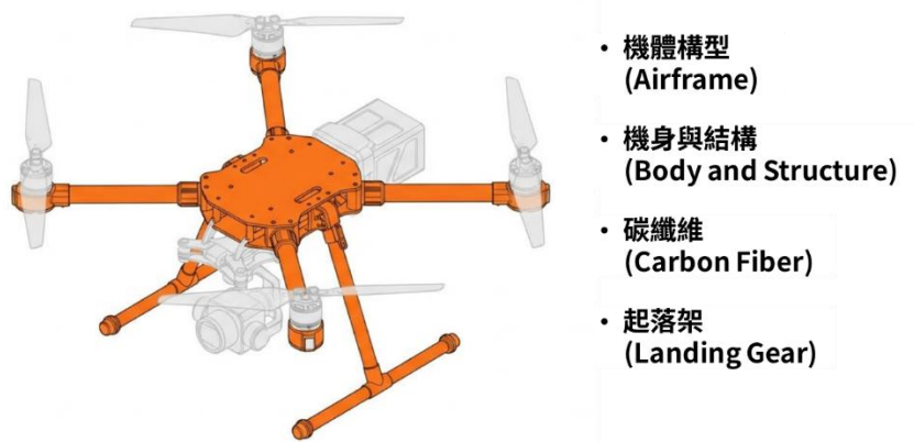
圖 4 機體 (Airframe) 示意圖
