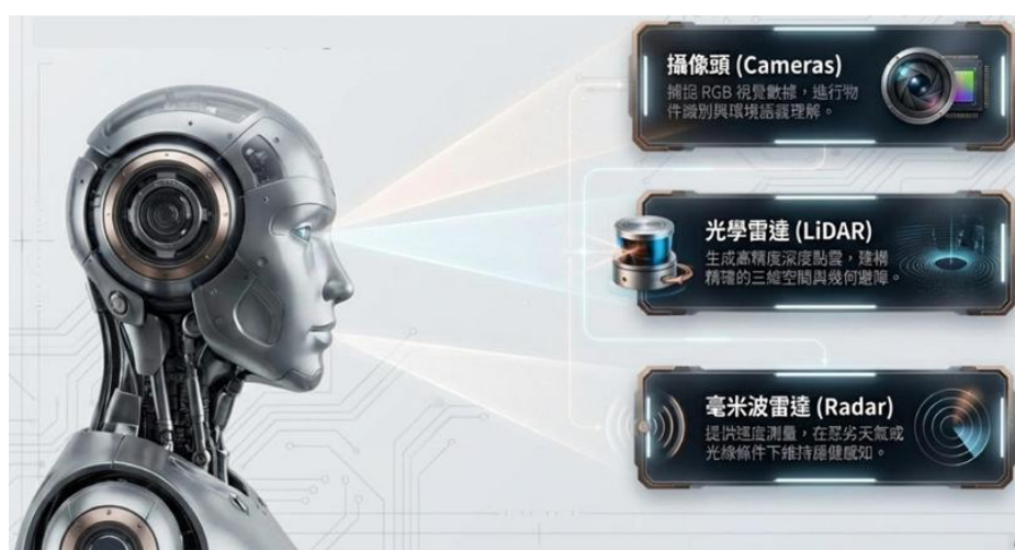
圖 31 外部感知之視覺系統(Vision Systems)示意圖
