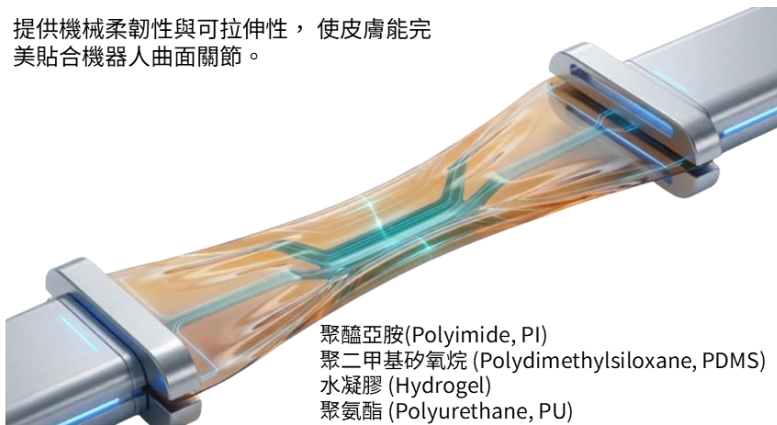
圖 47 電子皮膚柔性基材(Flexible Substrate)示意圖
