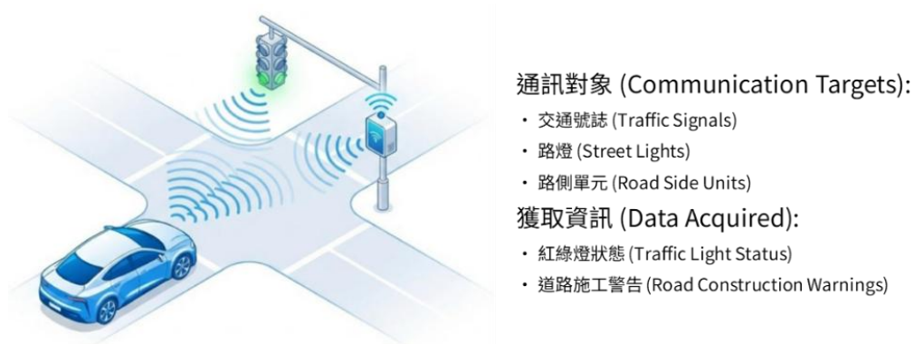
圖 37 車對基礎設施(Vehicle-to-Infrastructure, V2I)通訊示意圖
